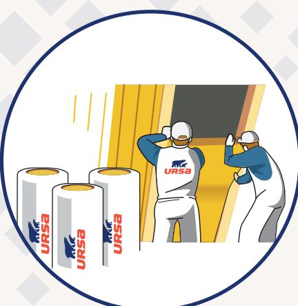
Aplikace minerální izolace URSA DF 35 mezi krovky. Izolaci mezi krovky postupně vkládáme lehkým vtláčením po obou stranách její výšky, až zaplníme celé krovkové pole. K zajištění izolace v krovkovém poli při aplikaci použijte fixační prvky např. drátkování.
