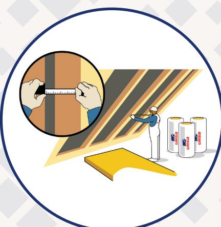
Změříme si šířku rozteče krovků. Pro zajištění lepší fixace minerální izolace URSA DF 35 mezi krovkami přidáme k naměřenému rozměru ještě 2 cm.
