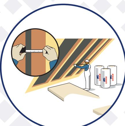
Změříme si šířku rozteče krovků. Pro zajištění lepší fixace minerální izolace URSA PUREONE USF 31 mezi krovkami přidáme k naměřenému rozměru ještě 1cm.
